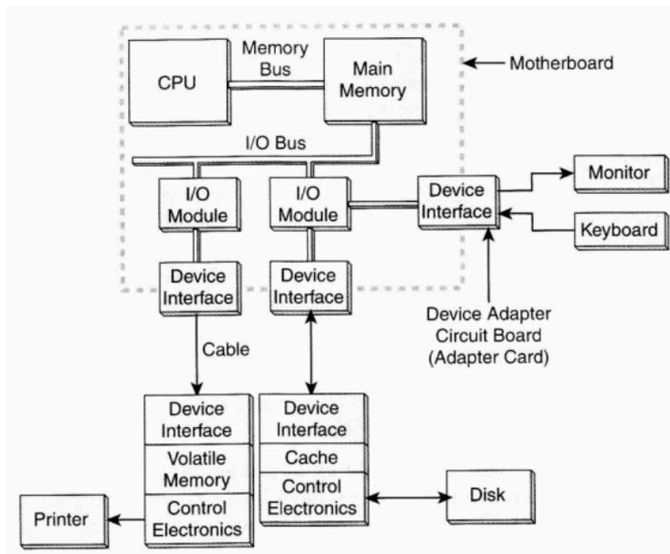
El **DMA** es un método avanzado en el que un controlador especial (controlador DMA) gestiona directamente la transferencia de datos entre un dispositivo periférico y la memoria principal, sin la intervención constante de la CPU. Este controlador comparte el mismo BUS de datos con el que la CPU se comunica con la Memoria. De esta forma la CPU le deja el trabajo al controlador y no interviene durante la transferencia de datos.
